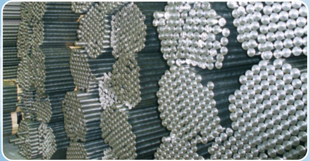
Los Aceros Inoxidables son **aleaciones de hierro-carbono con presencia de cromo en porcentajes superiores al 11%**. Dicho elemento facilita la formación de una **capa superficial de óxido de Cromo, que protege al resto del material de la oxidación**. Igualmente se incrementa la posibilidad de resistir a temperaturas elevadas sin formación de óxidos.
